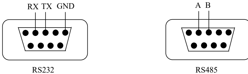
图 10 DB9 引脚功能图
